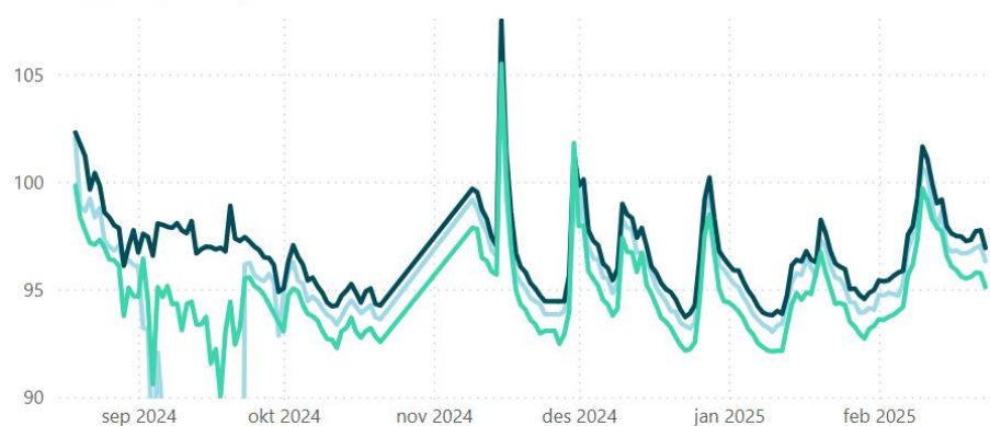
Figur 2 Oksygenivå målt ved flåte på hhv. 3, 13 og 23 meter gjennom produksjonsperioden
